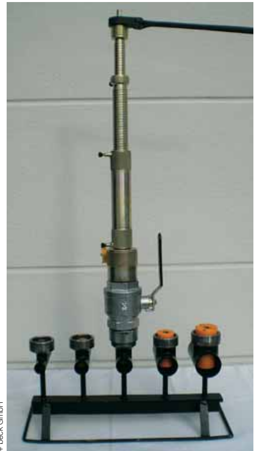
Abb. 2: Schleusenbohrgerät Maxi mit HA-Stopplesetztechnik 1-2 1/2" m. Vdr.-Messung
